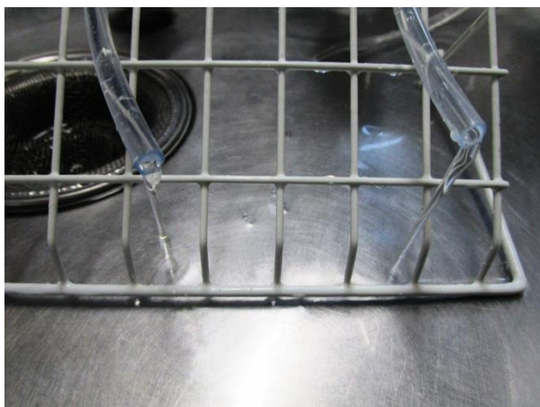
図 3 : 2 回路とも毎分 20mL に調整 (水漏れ程度のわずかな水量)
